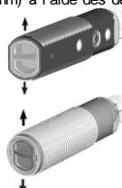
**S5N-ML:** L'installation du capteur peut être effectuée grâce au filetage M18x1 du corps sur un trou débouchant (Ø 18mm) à l'aide des deux écrous CH.24 (couple maximum de serrage 22Nm) fournis.
