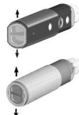
**S5N-ML:** L'installazione del sensore può essere effettuata grazie alla filettatura M18x1 del corpo su foro passante ( $\varnothing$  18 mm) utilizzando i due dadi CH.24 (coppia max di serraggio 22 Nm) in dotazione.
